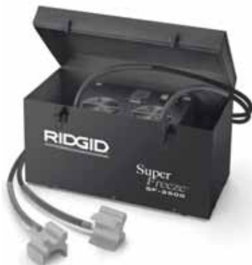
SF-2500 31 kg 230V ~ 50 Hz - 2.4A - 505W Pe1= 21 bares Pe2= 34 bares R 507 0,487kg ø máx: Fe 2". Cu 65 mm
