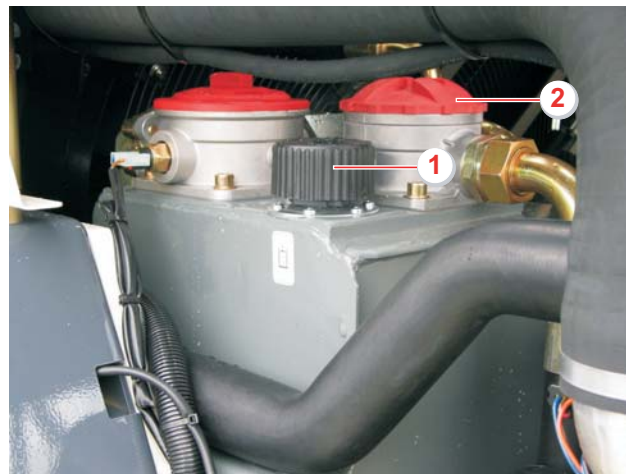
Afb. 6-29 Zuigfilter voor de hydrauliekolie vervangen
